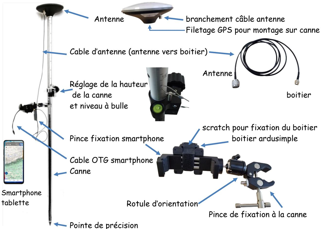
L'antenne utilisée est « AS-PROKIT-CALSURVEY-L1L2 » de ARDUSIMPLE
